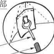
② コンテナ内部底4隅のレンケツリング③を立ち上げファイバー②に差し込みます。
